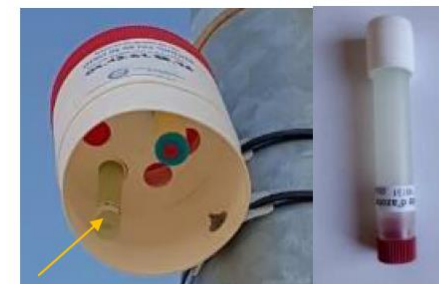
Echantillonneur passif Passam dans son abri
